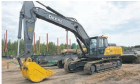
В Пинежский леспромхоз поступил новый, более мощный и тяжелый экскаватор. Он будет работать на строительстве капитального круглогодичного моста через Вашку. Виброголовка, установленная на технику, будет вбивать сваи в дно реки. Все необходимые для этого материалы уже приобретены и доставлены. Напомним, что постоянный мост будет готов к следующей зиме.
